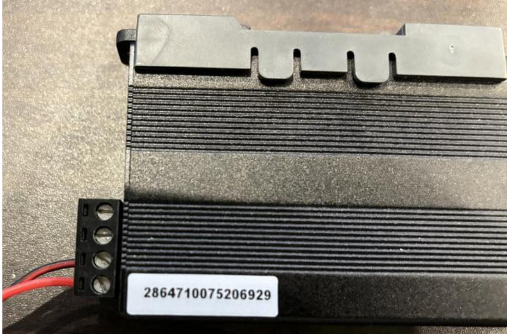
打开4G网关上位机配置工具后选择“设备管理”，然后点击“绑定设备”输入模块上面的ID号
