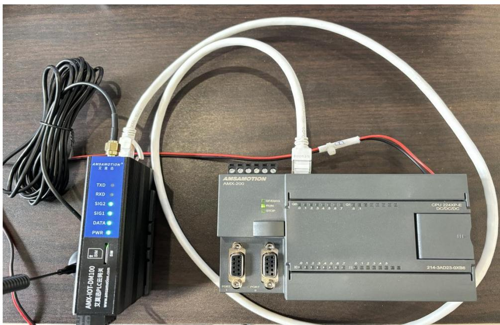
PLC连接网关前首先要确定PLC当前的IP，以PLC的默认的IP192.168.1.25为例
