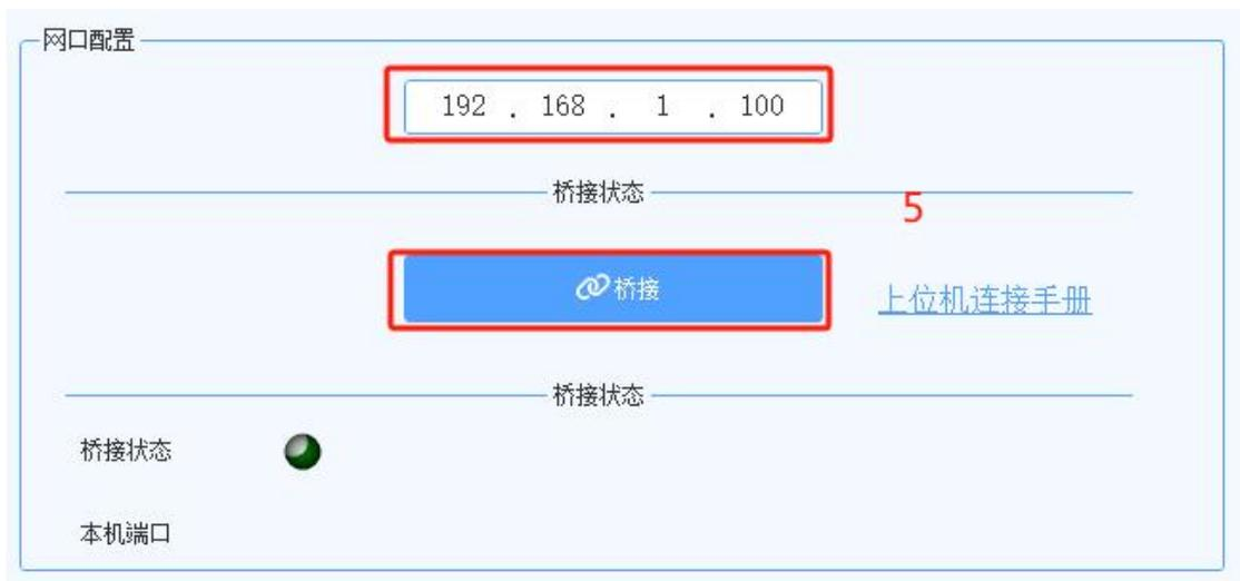
3.2.6、桥接完成后，下方会出现一个“桥接状态”和“请在PLC编程软件中填入的IP”
