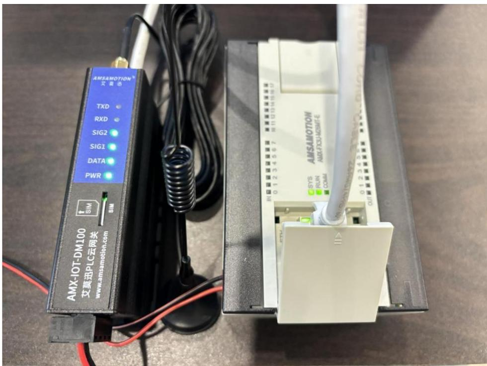
PLC 连接网关前首先要确定 PLC 当前的 IP，以 PLC 的默认的 IP192.168.1.18 为例
